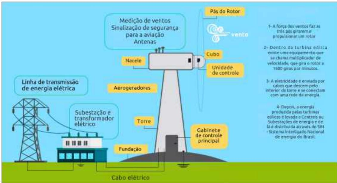
Figura 4: Como ocorre a geração de energia elétrica em um Complexo Eólico
