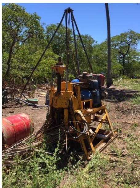
Fotografia 42 - Detalhe das sondas. Sondagem mista realizada na cabeceira da ponte sobre o rio Camaragibe. Clareira no Mangue. Lado direito. Acervo Encibra. Foto registrada em 16/01/2020.
