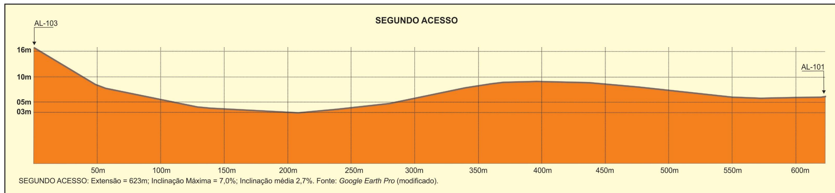
Figura 17 - Perfil de Elevação do Terreno para o segundo acesso. Obtido a partir do Google Earth Pro e reproduzido através do Corel Draw. Acervo Encibra.
